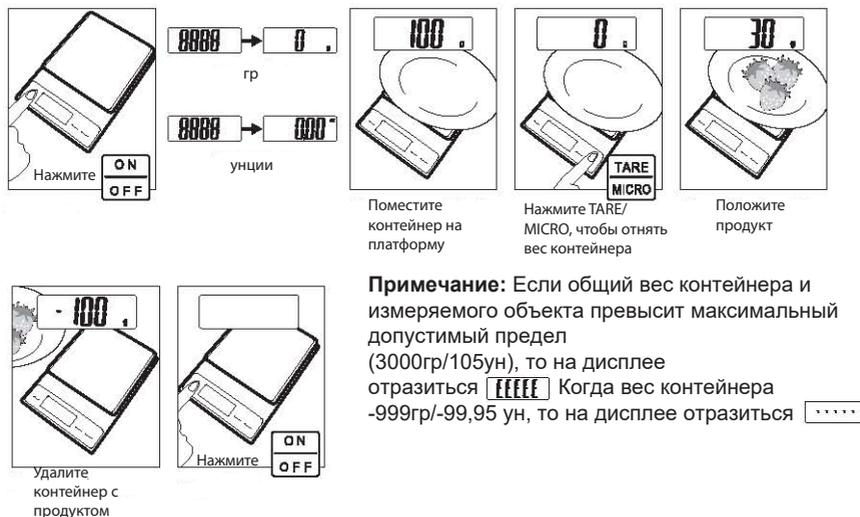
**Примечание:** Если общий вес контейнера и измеряемого объекта превысит максимальный допустимый предел (3000гр/105ун), то на дисплее отразится **EEEE**. Когда вес контейнера -999гр/-99,95 ун, то на дисплее отразиться **.....**
